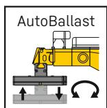
**Mit der AutoBallast-Funktion erfolgt der Ballastiervorgang vollautomatisch. Sämtliche Arbeitsschritte werden mit nur einem Knopfdruck erledigt.**
